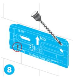
Injecter la colle dans le trou de remplissage (supérieur) jusqu'à ce qu'elle s'écoule par le bas.
