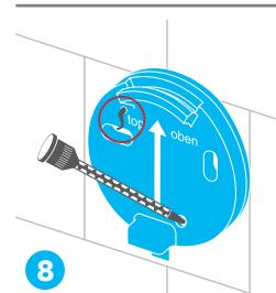
Injecter la colle dans le trou de remplissage (en bas) jusqu'à ce qu'elle s'écoule par le haut.
