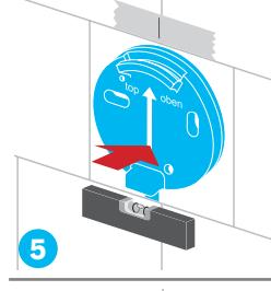
Schutzfolie abziehen. Flansch auf Wasserwaage waagrecht an Wand schieben.
