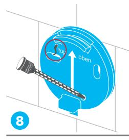
Klebstoff in Einfüllloch (unten) einpressen bis er oben austritt.
